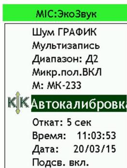
Для активации функции автокалибровки войдите в меню измерительной программы (см. пп.7.3, 7.4), выделите калибровочную поправку нужного канала и нажмите левую контекстную клавишу над экраном. Значения калибровочных поправок каждого датчика заменяются словом **«Автокалибровка»**.
