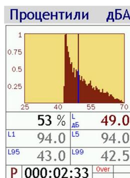
Расчет Процентилей L<sub>n</sub> для зоны обработки
