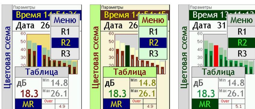
Клавиши [ВЛЕВО] и [ВПРАВО] переключают палитру цветов, которыми изображаются различные элементы экранных окон прибора. Клавиши [ВВЕРХ] и [ВНИЗ] регулируют яркость экрана.
