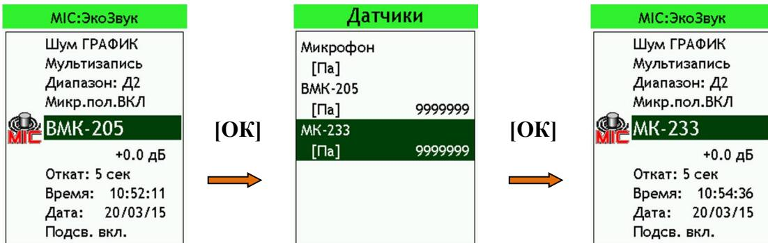
Выберите нужный датчик из списка клавишами **[ВНИЗ]** и **[ВВЕРХ]** и нажмите клавишу **[OK]**. Выбранный датчик и его калибровочная поправка появятся в меню измерительной программы.
