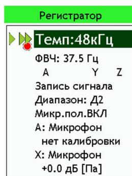
Чтобы сделать канал активным для выдачи телеметрии и записи в память, выделите клавишами со стрелками в третьей строке нужную позицию и нажмите клавишу **[OK]** (при выделении активные каналы выглядят так: **X**). Повторное нажатие клавиши **[OK]** сделает этот канал неактивным (при выделении неактивные каналы выглядят так: ).
