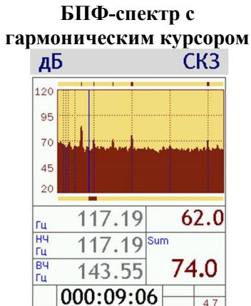
В верхней строке навигации над гармоническим курсором отображаются полосы пяти заданных порядков. При этом отображаются только те полосы, центральные частоты которых меньше верхней границы выбранной полосы в меню.
