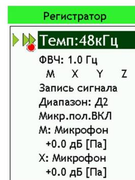
Эта программа позволяет осуществлять запись оцифрованных временных реализаций сигнала от входного канала в энергонезависимую память прибора, а также передавать эти реализации по телеметрии на внешние устройства.
