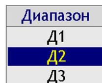
**Примечание 2.** **Д1** – наиболее грубый диапазон, предназначен для измерения высоких уровней; диапазон **Д2** может использоваться в подавляющем большинстве приложений; диапазон **Д3** используется при измерении слабых уровней.
