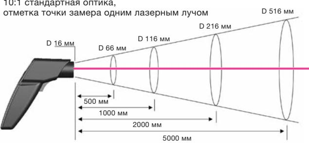
**Инфракрасный термометр с 2-х точечным лазерным
