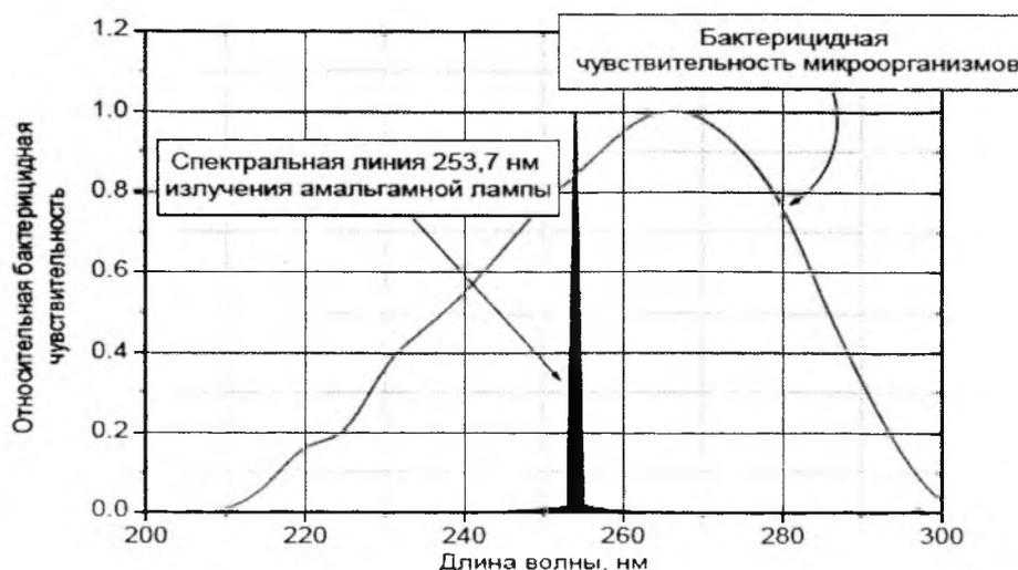
Рис. 2. Спектральное распределение излучения ртутной лампы высокого давления.
