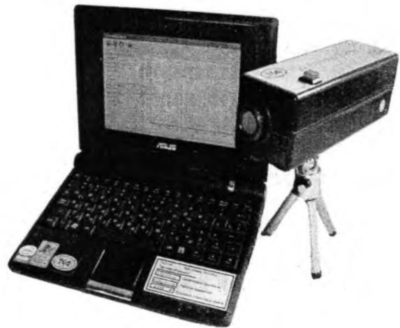
Рис. 5. Спектральный радиометр ТКА-ВД/УФ.
