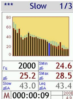
При вызове файла **Автозамера** мы попадаем на самый последний шаг записи. В левом нижнем углу экрана появляется символ **M**, который означает, что на экране представлены данные из памяти (memory) прибора. Справа от символа **M** указано, к какому моменту записи относятся эти данные.
