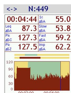
На графике в нижней части окна показано изменение во времени текущего уровня звука или вибрации. Зона обработки показана полосой светло-зелёного цвета (вертикальной для зоны обработки внутри выделенного участка - рисунок слева; и горизонтальной для зоны обработки по превышению порога – см. средний рисунок выше). При открытии файла выводится окно с зоной обработки внутри выделенного участка (с меткой **N:XX**), при этом вся мультизапись попадает в зону обработки.
