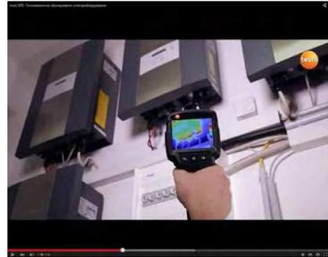
testo 870. Тепловизионное обследование электрооборудования
