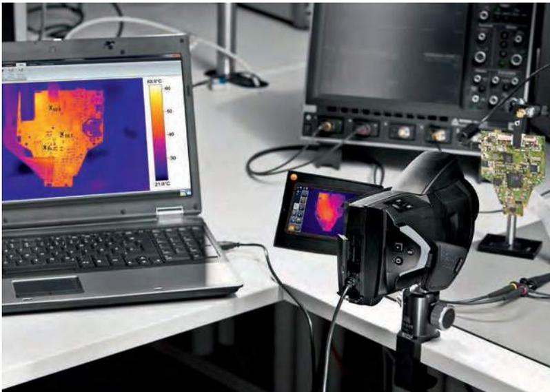
Любой фрагмент записи содержит данные температуры по каждому пикселю, что позволяет с точностью проанализировать все стадии процесса нагрева в течение определенного промежутка времени. Кроме того, функция регистрации данных обеспечивает возможность создания серии отдельных изображений в заданные временные интервалы или после определенных событий, например, превышения допустимых предельных значений.
