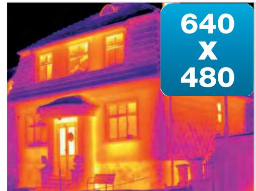
При регистрации самых незначительных перепадов температур особенно важным фактором является оптимальная температурная чувствительность (NETD). Тепловизоры Testo предлагают превосходную температурную чувствительность до < 30 мК, которая – в комбинации с высокой разрешающей способностью – позволяет визуализировать малейшие перепады температур независимо от размеров обследуемого объекта.
