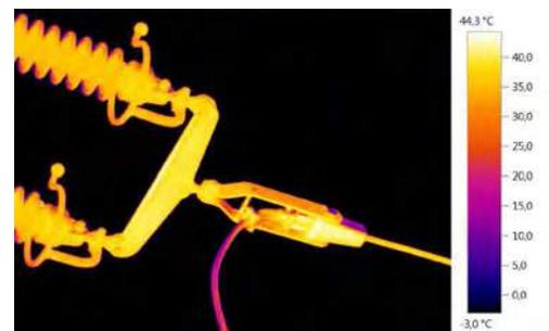
Тепловизионная съемка клеммного соединения изолятора (расстояние до объекта примерно 15 м)
