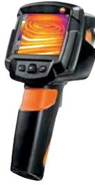
Тепловизор testo 870 был разработан с учетом требований организаций специализирующихся на монтаже систем отопления, в строительстве, специалистов по сервисному обслуживанию и руководителей служб эксплуатации. Он позволяет, к примеру, осуществлять обнаружение утечек в системах напольного отопления, локализовать мостики холода или визуализировать соединения с аномально высоким нагревом.
