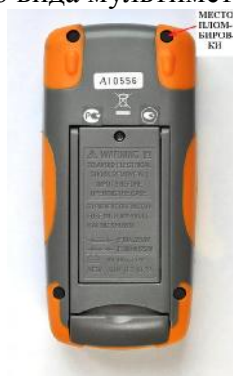
Рисунок 2 – Схема пломбировки от несанкционированного доступа.
