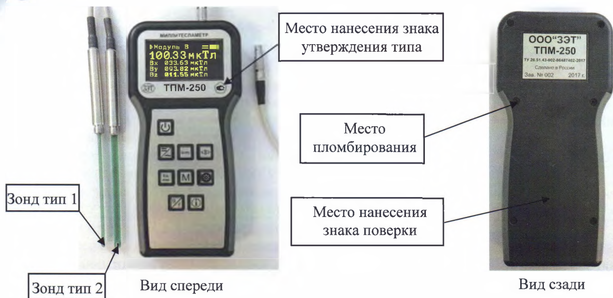
Рисунок 1 - Общий вид миллитесламетра
