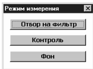
В закладке "Поиск" при запуске измерения всплывает окно "Режим измерения" для выбора режима измерения.
