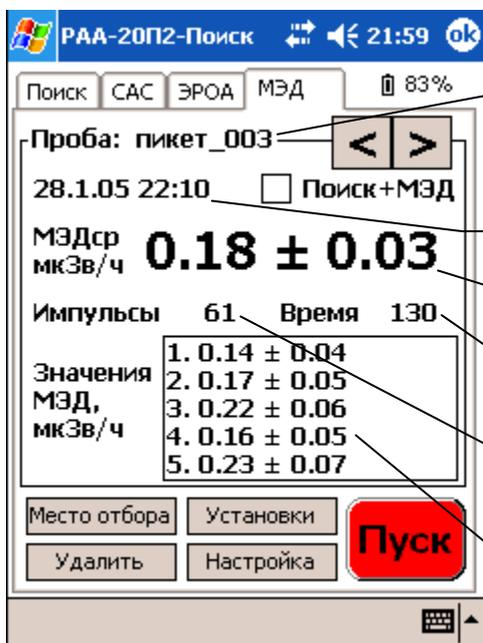
Номер пикета или фильтра, если измерения МЭД выполняются в автоматическом режиме
