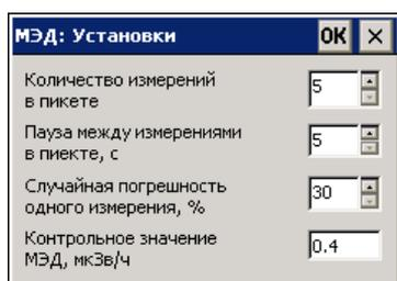
Кнопка **“Установки”** открывает окно "МЭД: Установки", в котором можно установить следующие параметры процедуры индикации и измерения МЭД в пикете:
