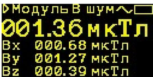
Рисунок 2.2. Пример отображения информации о том, что уровень измеряемого переменного магнитного поля ниже порога чувствительности прибора
