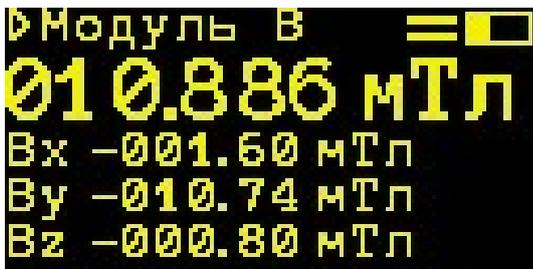
Рисунок 1.3. Режим измерения параметров постоянного магнитного поля
