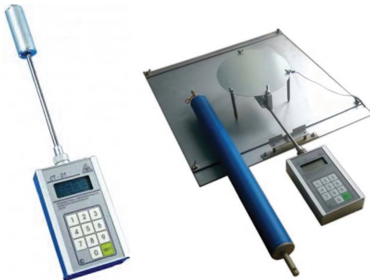
Рисунок 1 — Прибор для измерения напряженности электростатического поля СТ-01
