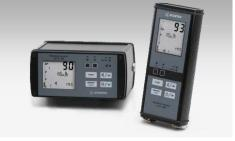
2) <u>БОИ4</u> представляет собой карманный персональный компьютер (КПК) со встроенным узлом детектирования, обеспечивающем измерение дозы и мощности дозы гамма-излучения в месте нахождения оператора. Алгоритм работы обеспечивает непрерывность
