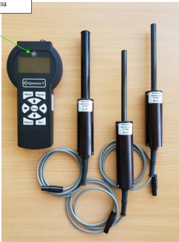
Рисунок 1 - Общий вид измерителя ПЗ-91 и место нанесения знака утверждения типа
