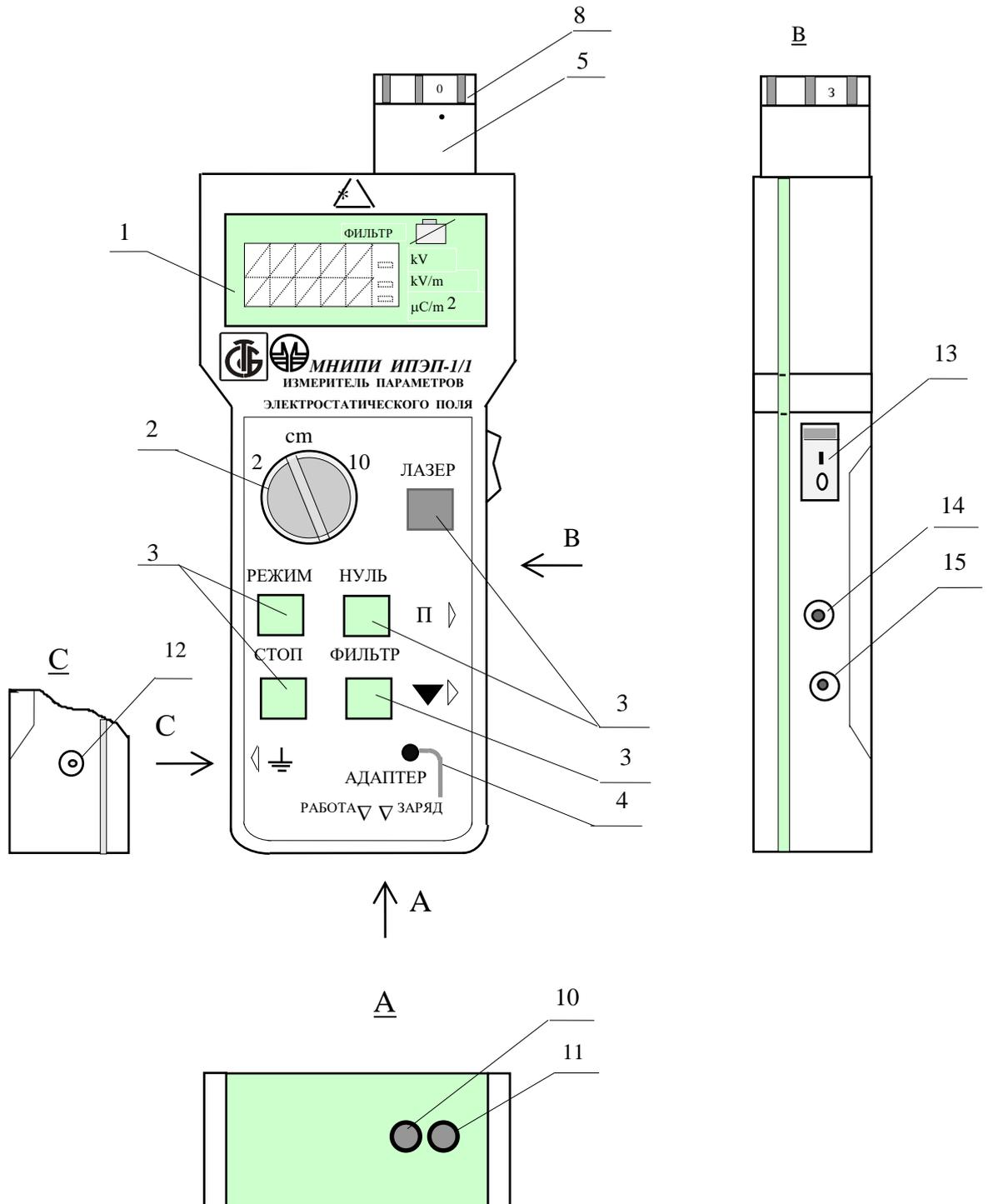
Рисунок 2.2 - Схема расположения органов управления и подключения измерителя электростатического поля ИПЭП-1/1
