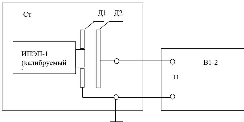
Ст – стенд УШЯИ.441219.003 или приспособление, обеспечивающее крепление измерителя и дисков и установку расстояния между ними  $2 \pm 0,03$  см;
