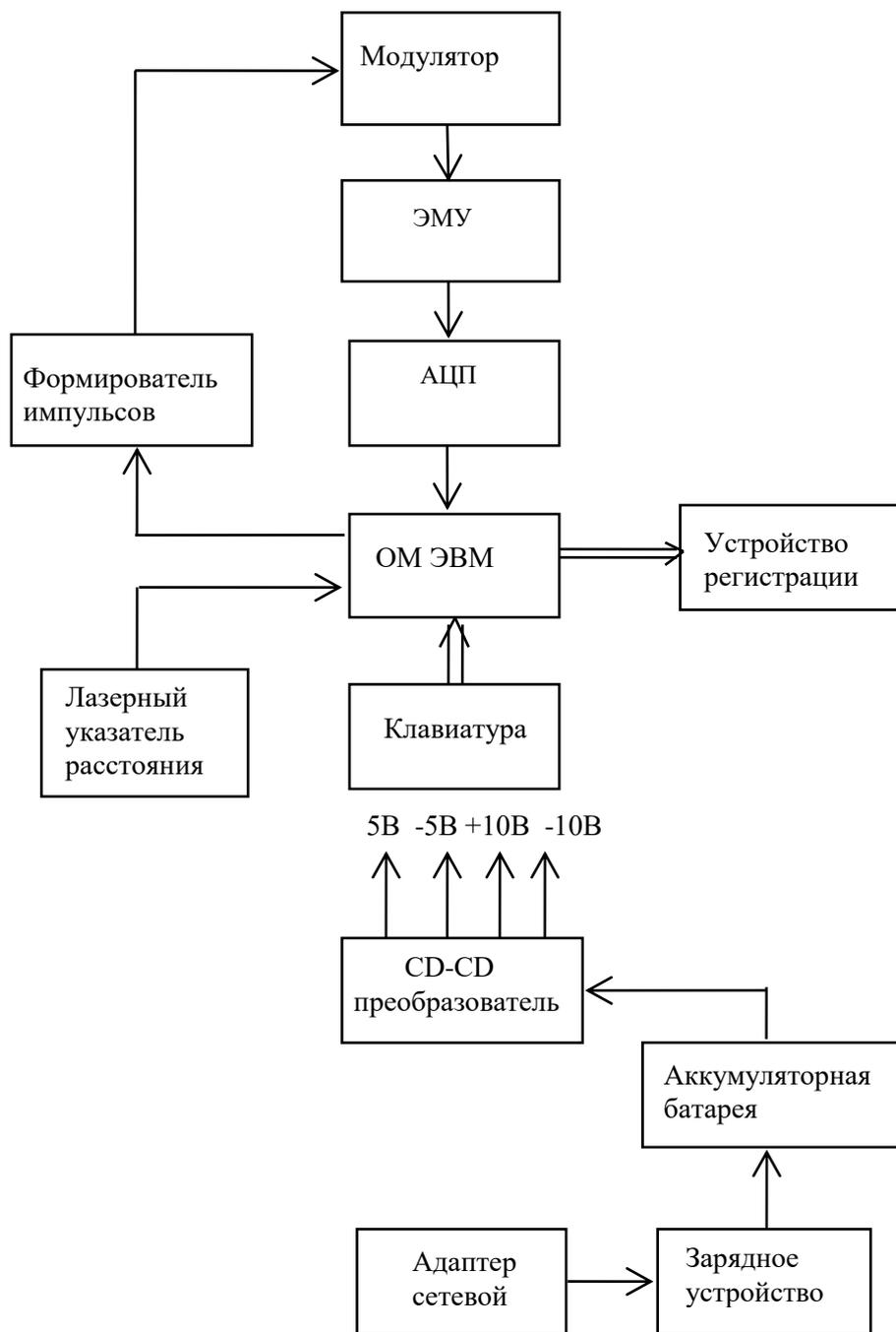
Рисунок 1.3 Структурная схема измерителя
