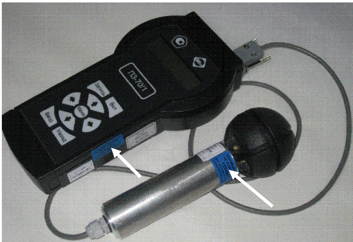
Рисунок 1 – Общий вид измерителя (стрелками обозначены места пломбирования корпусов составных частей измерителя)
