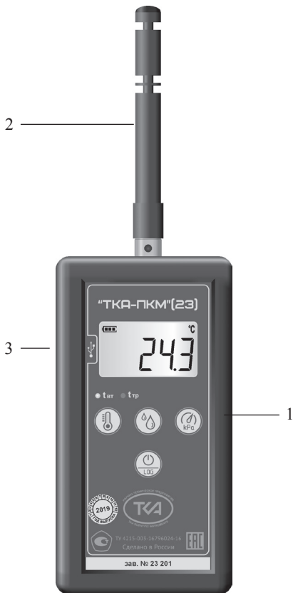
Рис.1 – Внешний вид прибора “ТКА-ПКМ”(23) 1 – Блок обработки информации 2 – Измерительная головка 3 – Разъём для подключения к ПК
