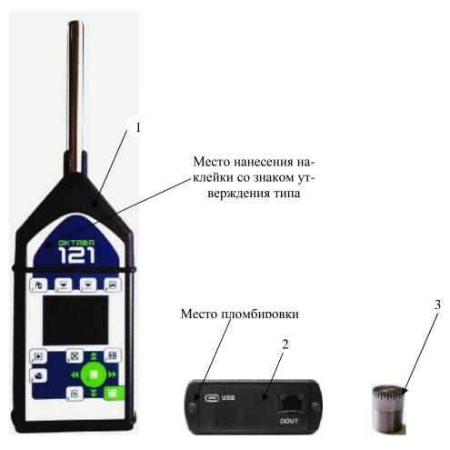
1 – Лицевая панель шумомера; 2 – шумомер - вид снизу; 3 – микрофонный капсюль
