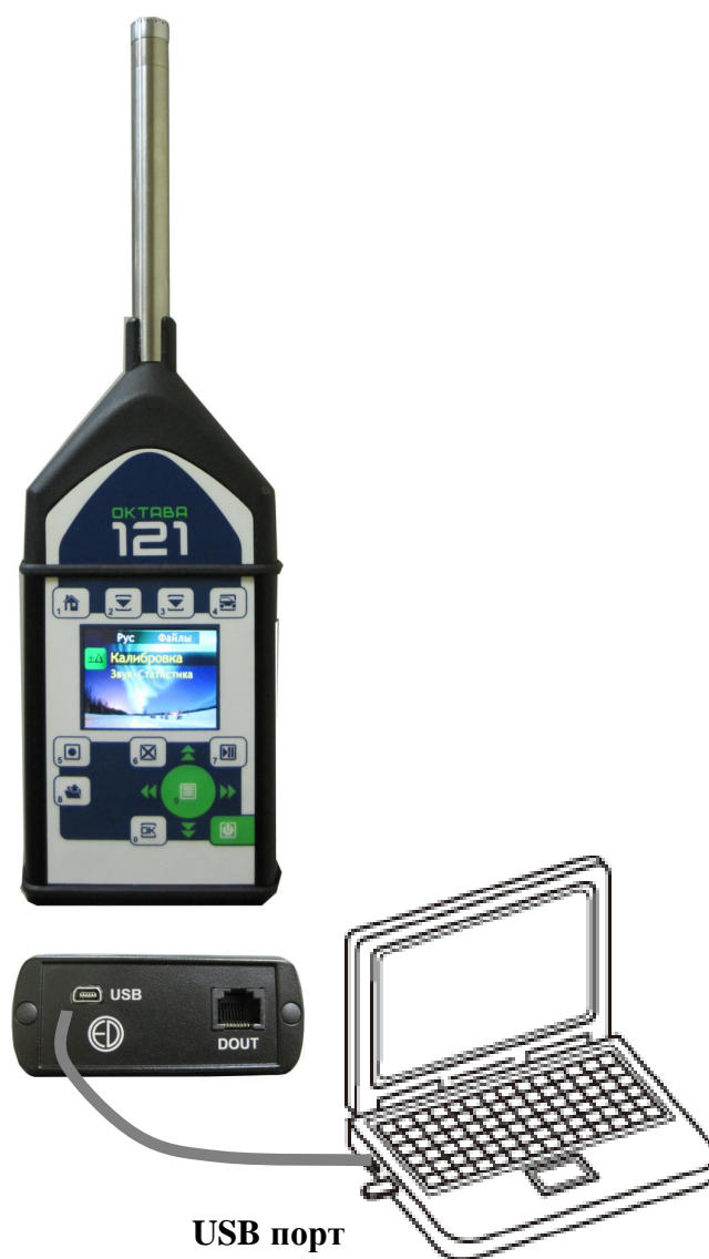
Схема 5. Схема подключения прибора к компьютеру для обмена файлами
