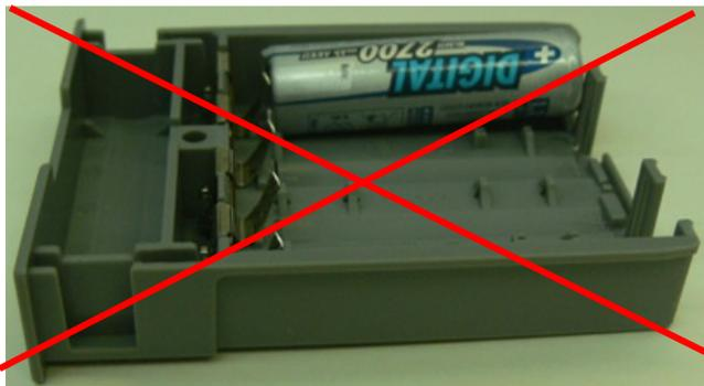
Аккумулятор установлен под некоторым углом
