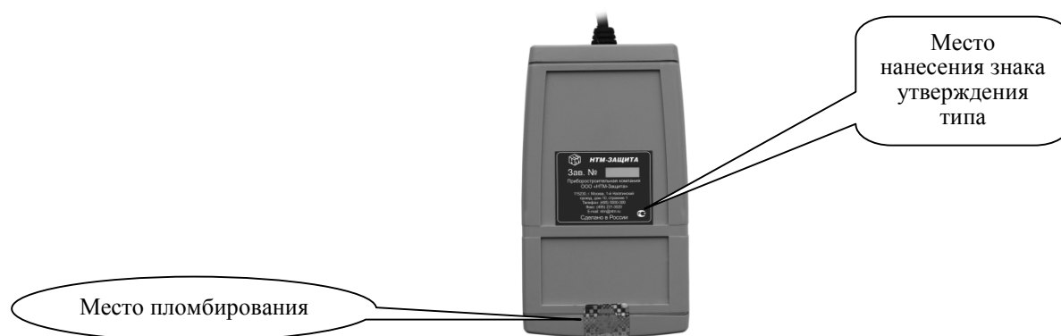
Рисунок 2 – Схема пломбировки от несанкционированного доступа и место нанесения знака утверждения типа
