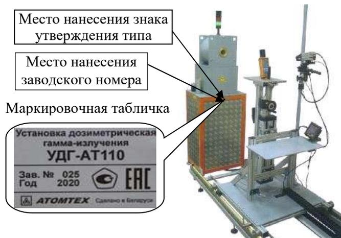
Рис. 1 Общий вид установки дозиметрической гамма-излучения УДГ-АТ110
