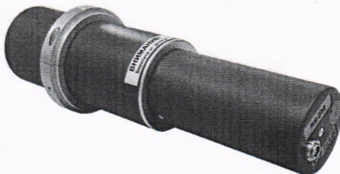
Рисунок 1.2 – Фотография общего вида блока детектирования гамма-излучения БДКГ-11С
