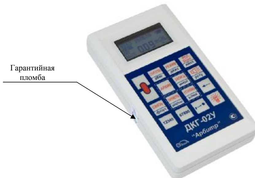
Рисунок 1 – Внешний вид и место опломбирования дозиметра
