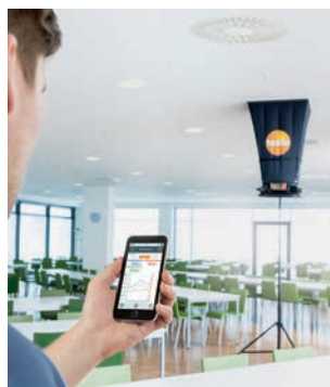
Мобильное приложение, подключаемое по Bluetooth, позволяет отображать данные измерений на экране мобильного устройства и создавать протоколы измерения прямо на месте замера.
