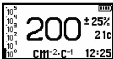
Алгоритм обработки информации, результат которой индицируется с помощью динамической шкалы – «Следящий», независимо от типа алгоритма, выбранного оператором. Это обеспечивает возможность оперативного визуального отслеживания динамики изменения интенсивности регистрируемого излучения.
