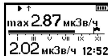
При обнаружении локальной зоны с уровнем радиации, превышающим фоновый уровень более чем в двенадцать раз, дозиметр-радиометр подает звуковой сигнал тревоги. Для продолжения поиска в зоне с повышенным уровнем радиации (фоновой), целесообразно обновить базовое значение фонового уровня, выполнив действие ►►.
