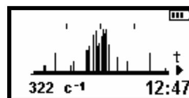
и в виде звуковых сигналов регистрации гамма-квантов. Указанный аудио сигнал генерируется в момент фиксации интенсивности излучения, мгновенное значение которого примерно вдвое превышает значение фонового уровня. Увеличив коэффициент деления частоты звуковых сигналов регистрации квантов, выполнив действие  $\uparrow \uparrow$  можно получать только аудио сигналы режима «Обнаружение».
