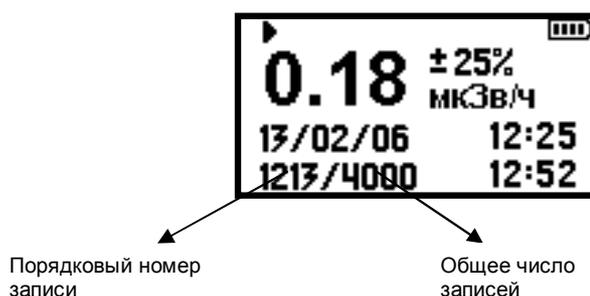
Результаты измерений могут сохраняться в архиве автоматически, если в пункте меню «Настройка»-«Алгоритм» разрешено «Автосохранение», или вручную, при выполнении действия ►, но лишь в том случае, если разрешена индикация окна «Архив»:
