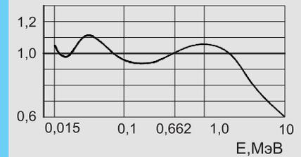
Типовая энергетическая зависимость чувствительности дозиметров относительно энергии 662 кэВ гамма-излучения <sup>137</sup>Cs
