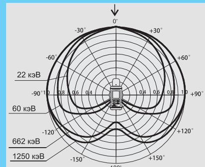
Типовая анизотропия дозиметра для горизонтальной плоскости
