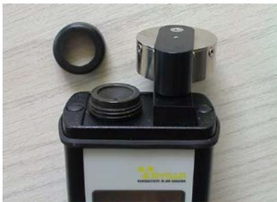
После этого, необходимо открутить зажим фильтра против часовой стрелки и извлечь старый фильтр. Необходимо избегать поворота измерительной головки более чем на  $90^{\circ}$  во избежание разрыва проводов. **Недопустимо**
