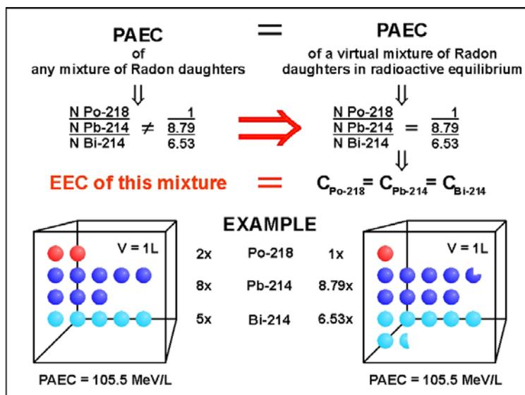
Это обуславливает линейную зависимость между измеренной PAEC и результирующей концентрацией активности, называемой эквивалентной равновесной концентрацией (EEC).
