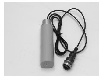
Подключите к пульту выносной блок детектирования БДГ-01. Выберите канал измерения 4 (в соответствии с п.6.1.2.) и произведите измерения.
