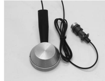
Подключите к пульту выносной блок детектирования БДБА-02. Оденьте крышку-фильтр (сплошная) поз.5 (Рис.3) на блок. Выберите канал измерения 3 (в соответствии с п.6.1.2.), поместите выносной блок на исследуемую поверхность и произведите несколько измерений фона датчика.
