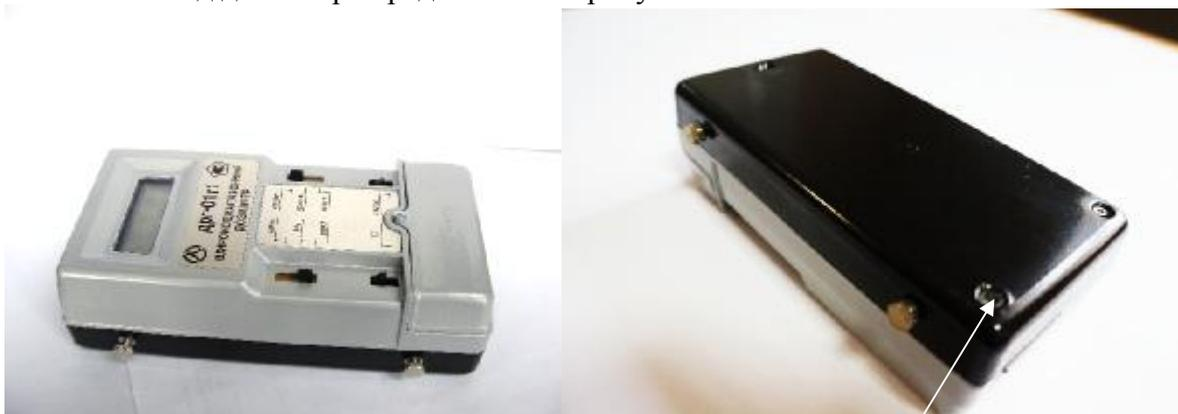
Место пломбирования от несанкционированного доступа
