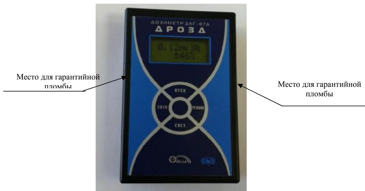
Рисунок 1 – Внешний вид и места пломбирования дозиметра
