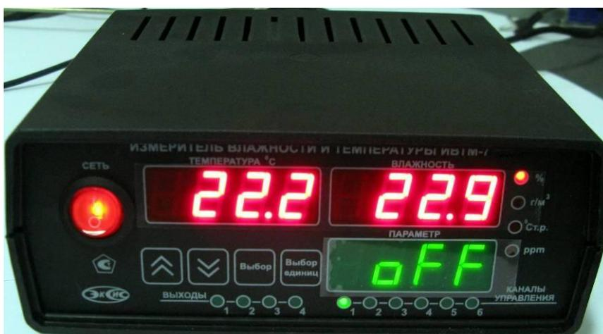
Рисунок 24. Модификация ИВТМ-7 /X исполнения ИВТМ-7 /X-С
