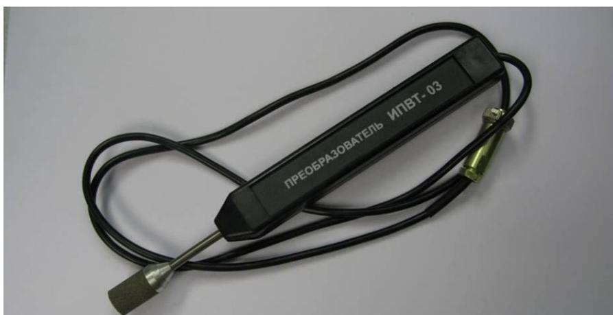
Рисунок 26. Измерительный преобразователь ИПВТ-03-01
