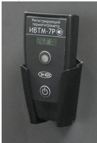
Рисунок 11. Модификация ИВТМ-7 Р исполнения ИВТМ-7 Р-03
