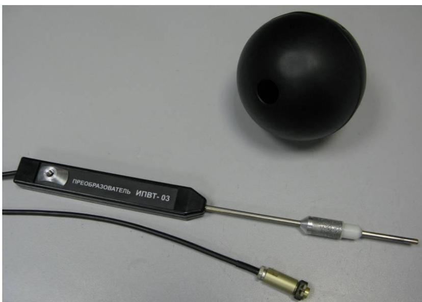
Рисунок 33. Измерительный преобразователь ИПВТ-03-09
