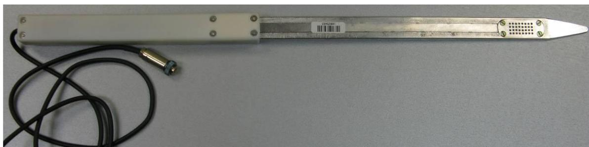
Рисунок 34. Измерительный преобразователь ИПВТ-03-11
