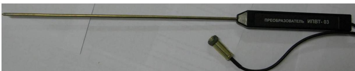
Рисунок 30. Измерительный преобразователь ИПВТ-03-05
