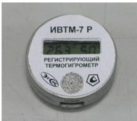
Рисунок 10. Модификация ИВТМ-7 Р исполнения ИВТМ-7 Р-02
