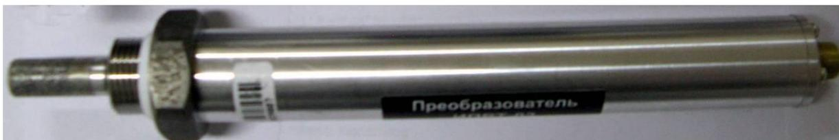
Рисунок 31. Измерительный преобразователь ИПВТ-03-06
