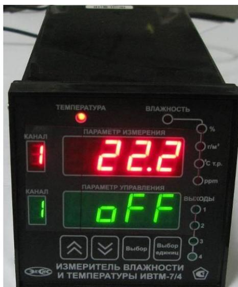
Рисунок 23. Модификация ИВТМ-7 /X исполнения ИВТМ-7 /X-Щ2
