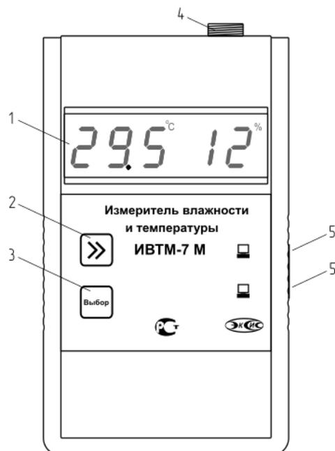
Рисунок 3.3 Внешний вид измерительного блока ИВТМ-7 М 3
