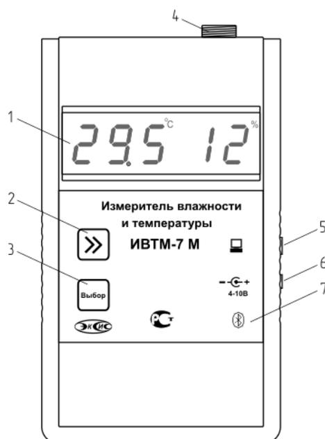
Рисунок 3.6 Внешний вид измерительного блока ИВТМ-7 М 7
