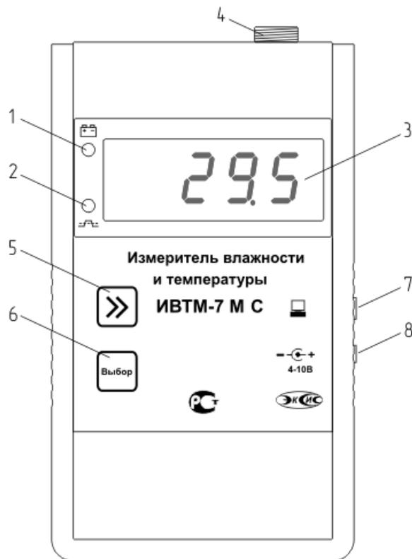
Рисунок 3.8 Внешний вид измерительного блока ИВТМ-7 М С
