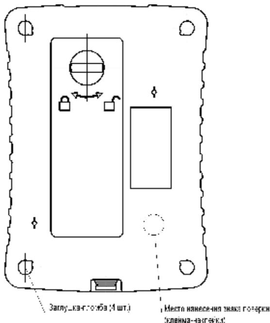
Рисунок 2 – Место нанесения знака поверки (клейма-наклейки)
