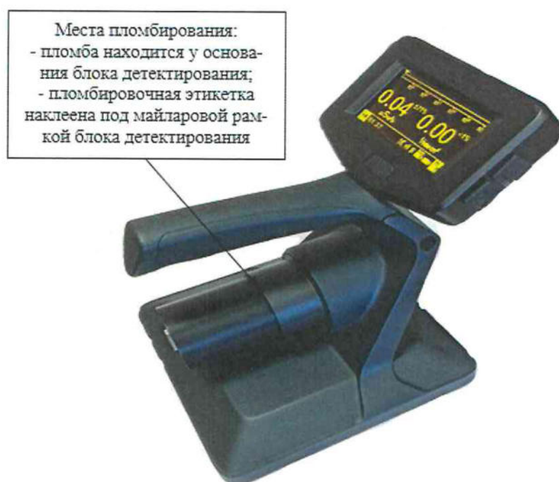
Рисунок 2 – Общий вид дозиметра-радиометра с блоком детектирования БДЗБ-Р5Д (в сборе с УПИ-01Д, МБС-3) и схема пломбировки
