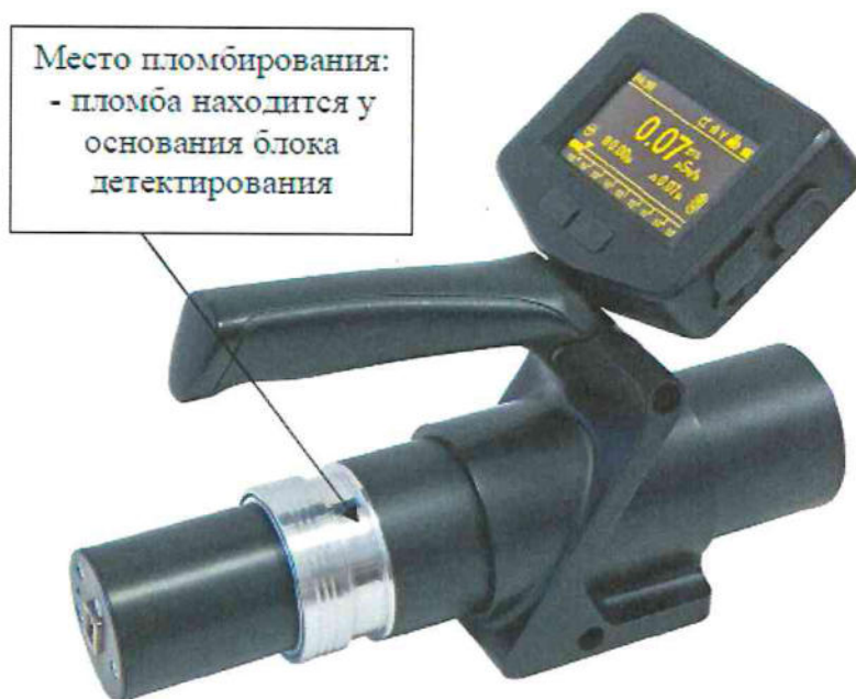
Рисунок 1 – Общий вид дозиметра-радиометра с блоком детектирования БДКГ-Р20Д (с держателем, УПИ-01Д, МБС-3) и схема пломбировки
