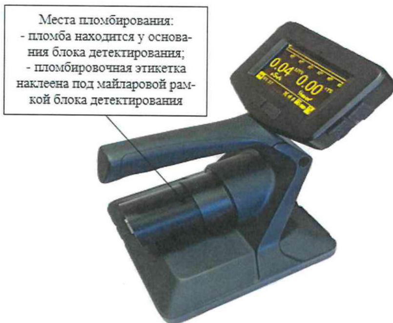
Рисунок 3 – Общий вид дозиметра-радиометра с блоком детектирования БДЗА-Р5Д (в сборе с УПИ-01Д, МБС-3) и схема пломбировки
