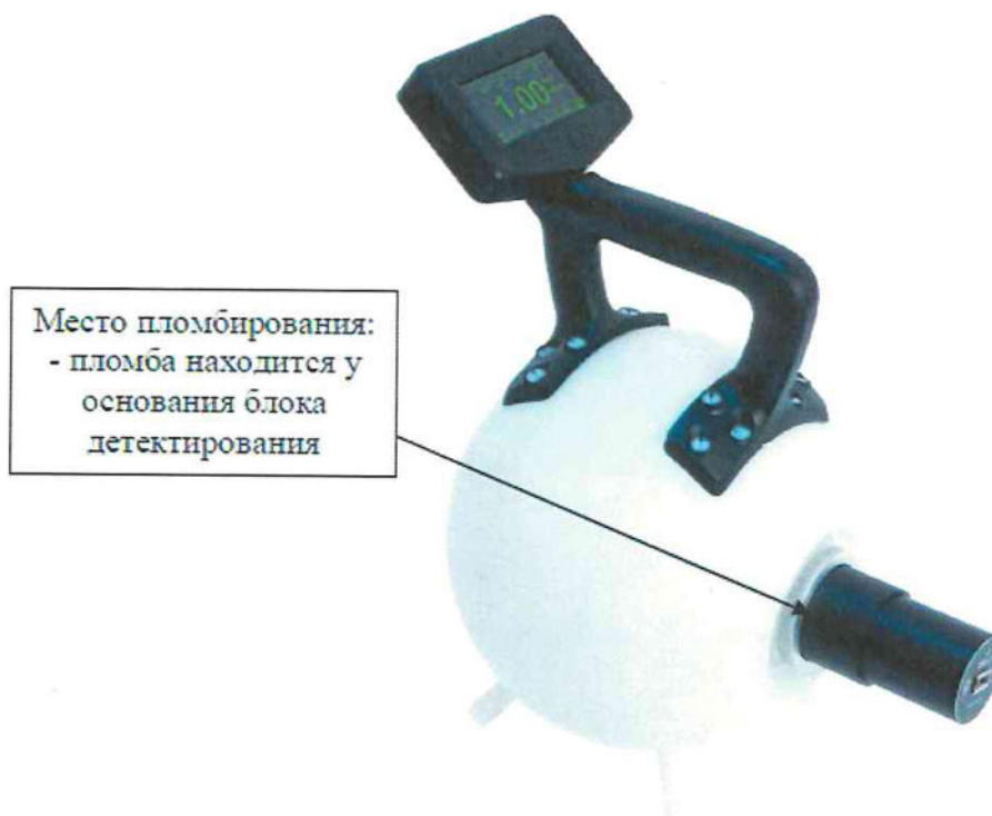
Рисунок 4 – Общий вид дозиметра-радиометра с блоком детектирования БДКН-Р5Д (в нейтронном замедлителе, с УПИ-01Д, МБС-3) и схема пломбировки
