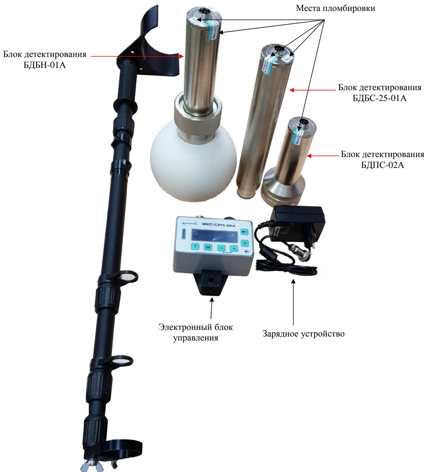
Рисунок 1 – Общий вид дозиметра-радиометра поискового МКС/СРП-08А для использования на железнодорожном транспорте и общего применения
