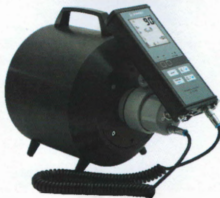
Рисунок 2 – Прибор в составе с БДКН-03 и БОИ2
