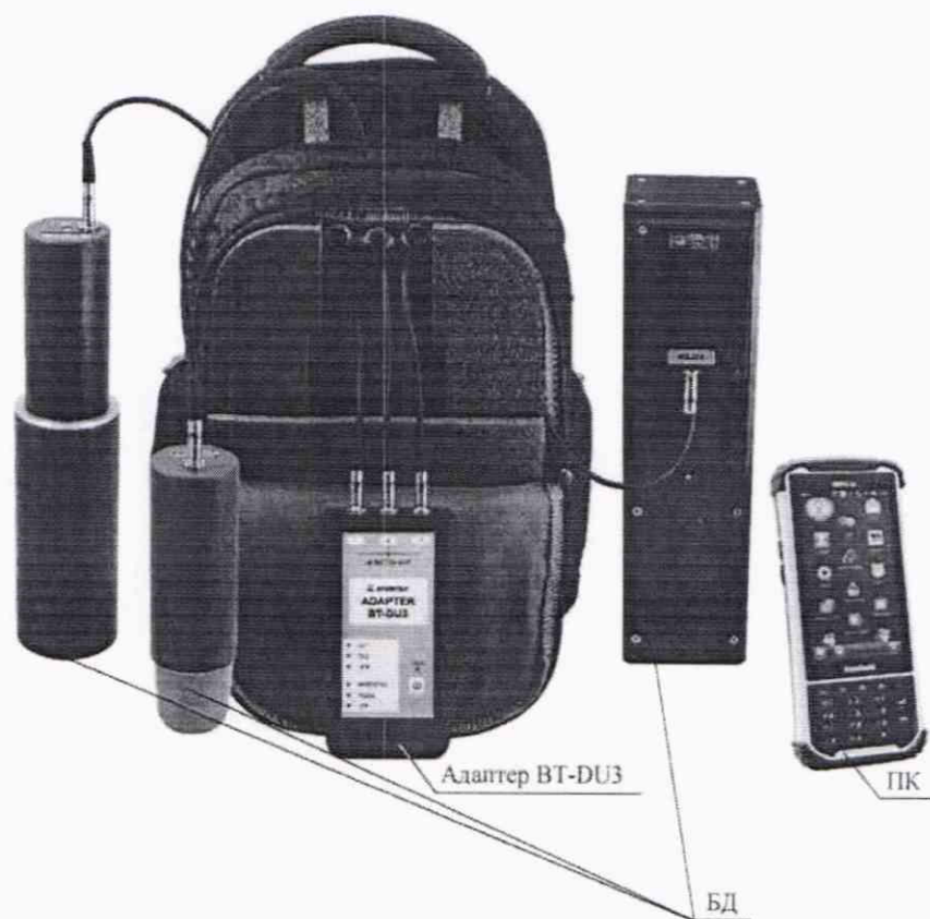
Рисунок 1.1 – Фотография общего вида спектрометров в рабочей упаковке «рюкзак» (изображение носит иллюстративный характер)
