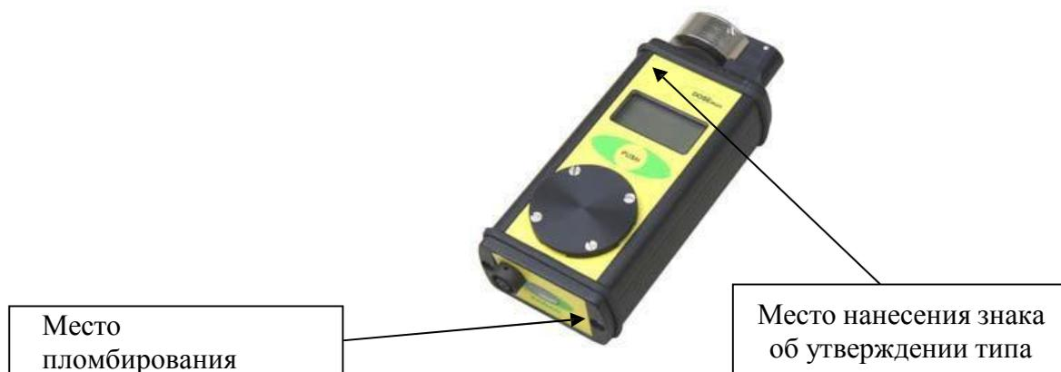
Рисунок 1 – Внешний вид радиометра
