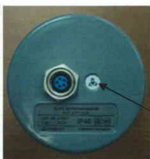
Рисунок 2 – Место пломбирования от несанкционированного доступа
