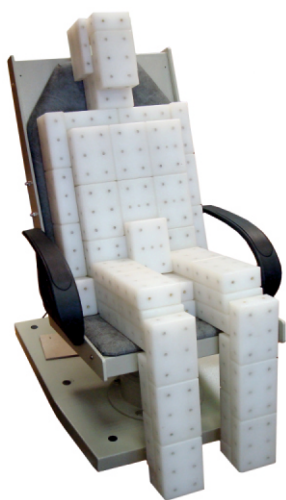
Калибровка СИЧ с использованием фантома тела человека
