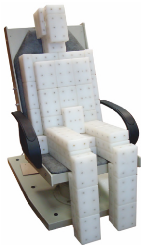
Калибровка СИЧ с использованием фантома тела человека
