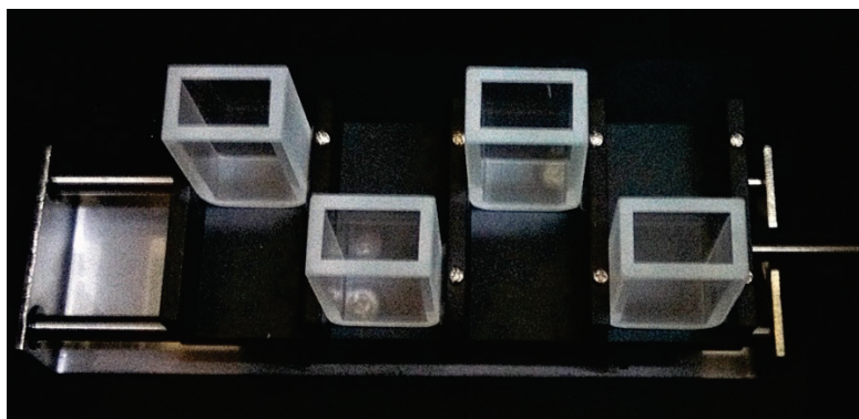
Рисунок 2 - Установка кювет в шахматном порядке.
