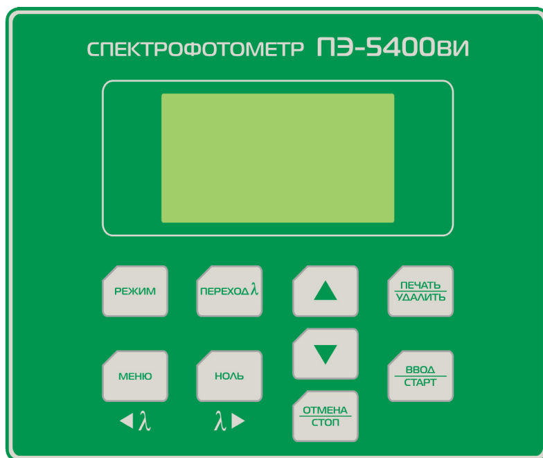
Рисунок 4 - Панель управления спектрофотометра ПЭ-5400ВИ.
