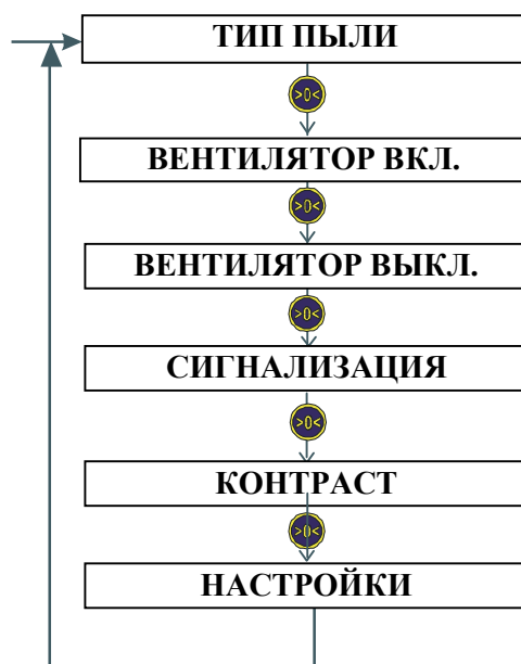
Рис. 5.5. Структура меню прибора АЭРОКОН-П
