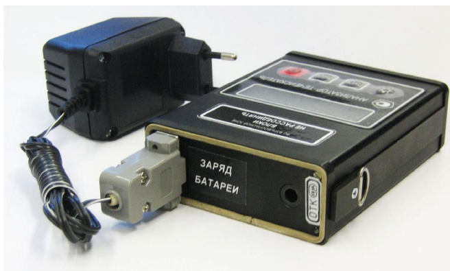
Рисунок 7.1. Подключение зарядного устройства к блоку ОИ.
