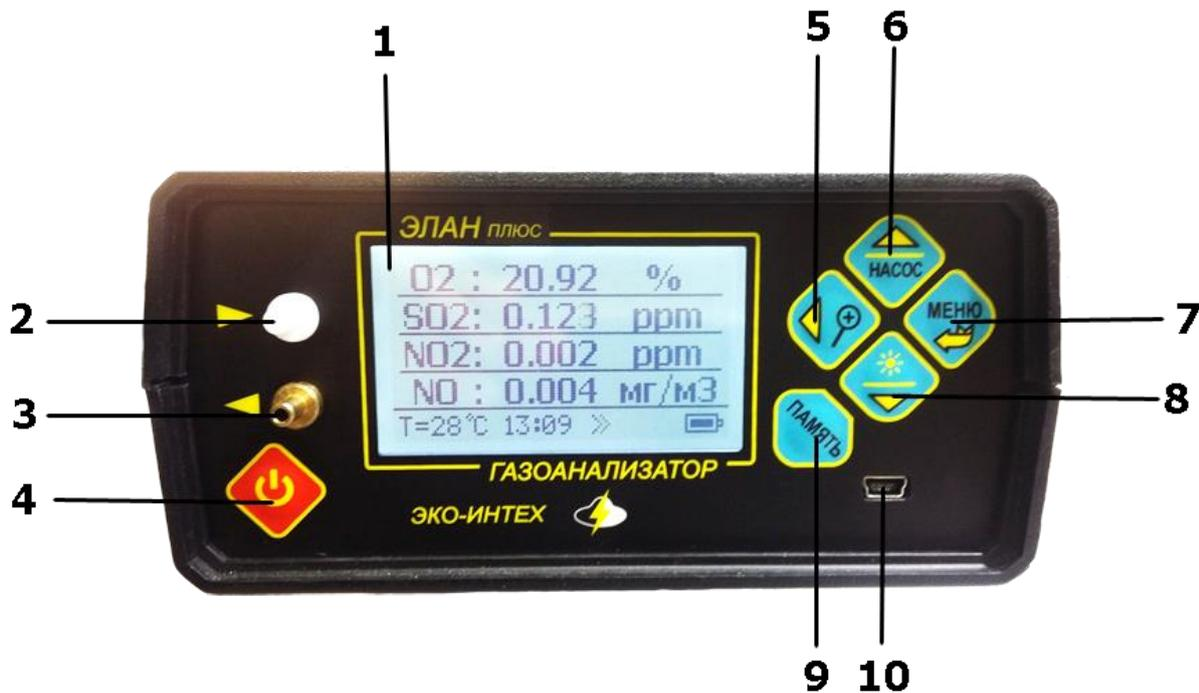
Рис. 1. Вид со стороны лицевой панели газоанализатора
