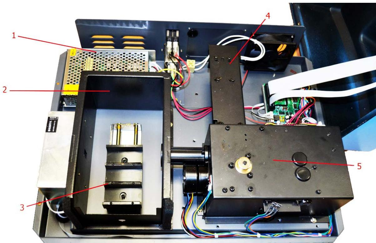
Рисунок 30 - Внутренняя платформа. Обозначения: 1 - радиатор; 2 - кюветное отделение; 3 - кюветодержатель; 4 - крышка лампы; 5 -отсек монохроматора.
