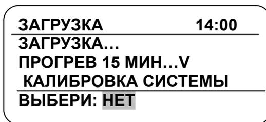
Рисунок 4. Предложение откалибровать систему при запуске прибора.
