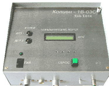
Рис. 3. Фотография внешнего вида газоанализатора КОЛИОН-1В-03С, БИ.
