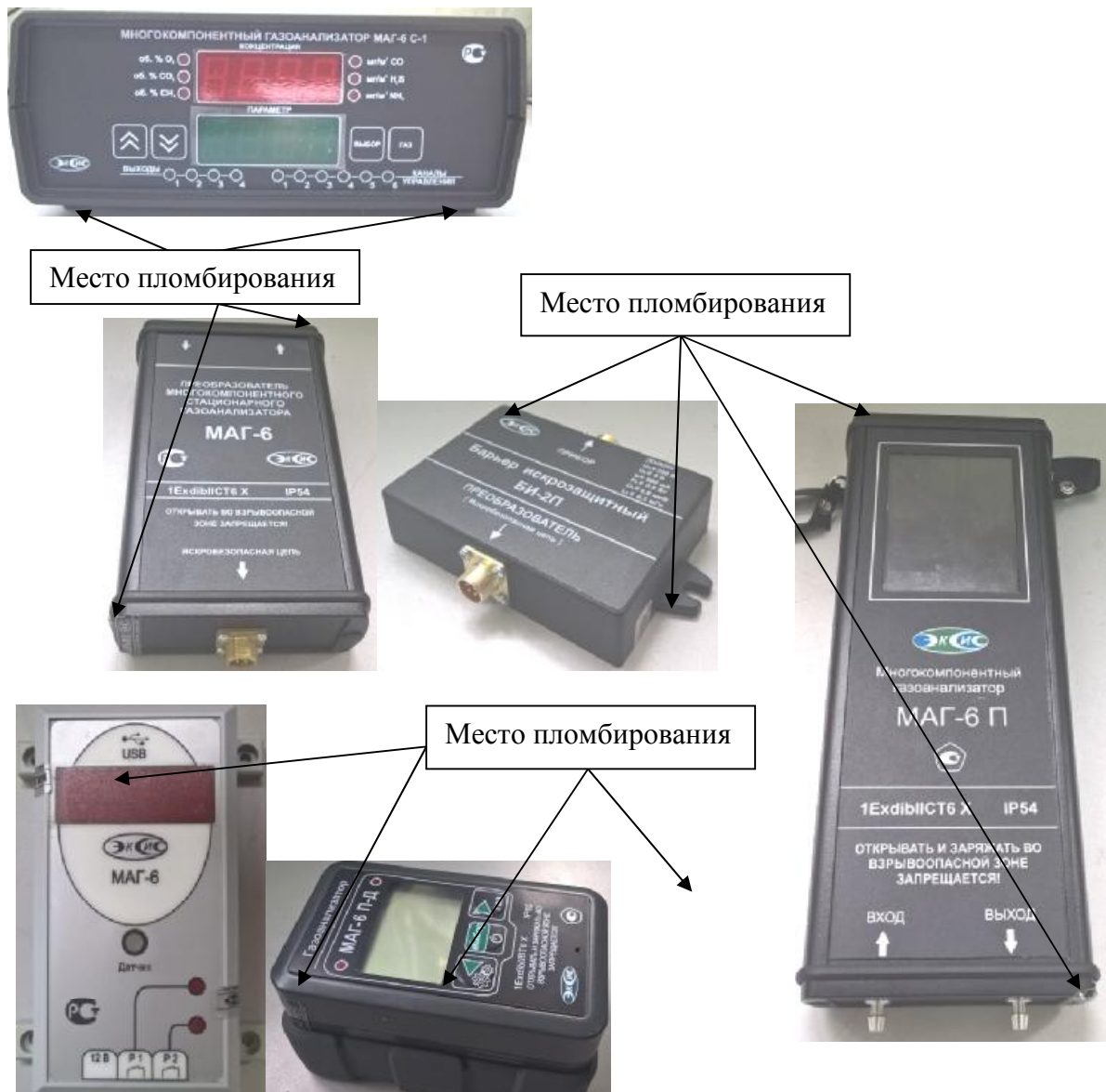
Стрелками указаны места пломбирования от несанкционированного доступа Рисунок 9 Схема пломбирования газоанализаторов от несанкционированного доступа
