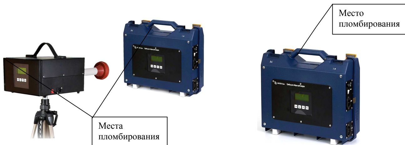
Рисунок 1 – Фотография общего вида с указанием места пломбирования приборов исполнения ПА-300М-1
