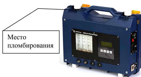
Рисунок 4 – Фотография общего вида с указанием места пломбирования приборов исполнения ПА-300М-2
