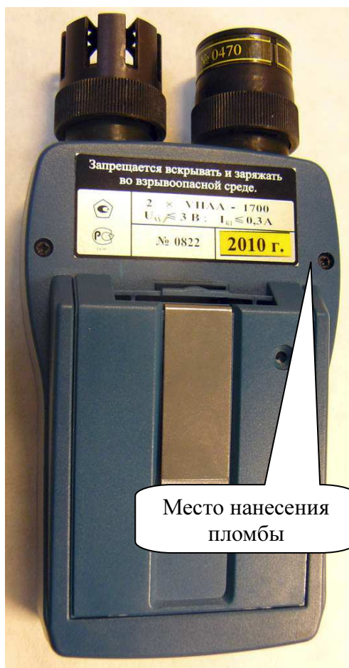
Рисунок 2 – Схема пломбирования газоанализатора от несанкционированного доступа
