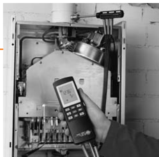
Анализ дымовых газов с помощью testo 327, 330-1LL, 330-2LL
