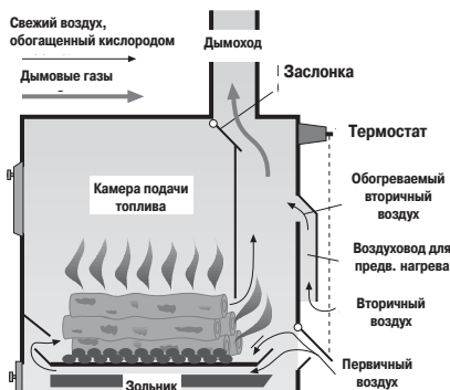
Рис. 6: Простая колосниковая печь
