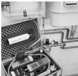
Проведение предварительного теста с использованием прибора testo 312-3
