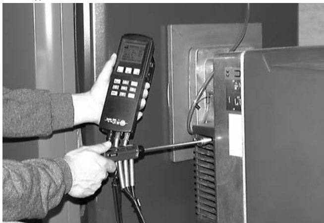
Рис. 12: Измерение температуры воздуха, идущего на горение
