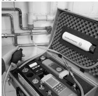
Проведение основного теста с использованием прибора testo 312-2/3
