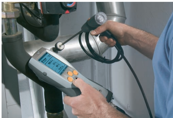
Рис. 13: Определение уровня потерь тепла с дымовыми газами
