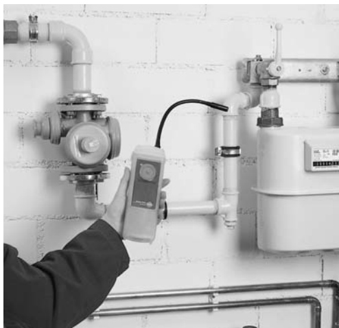
Рис. 26: Обнаружение утечки газа в трубах с помощью testo 316-1
