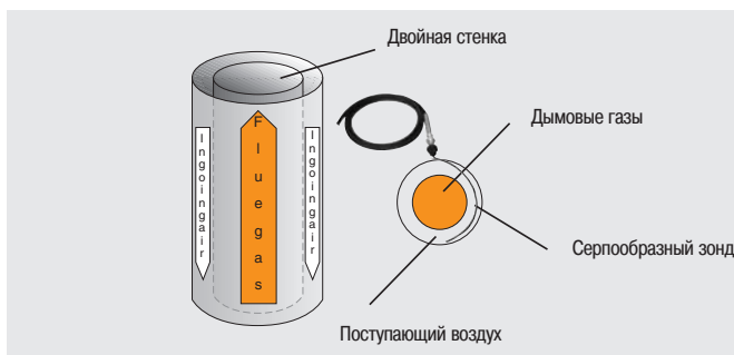
Рис. 20: Замер уровня O_2 в межстенном пространстве дымохода
